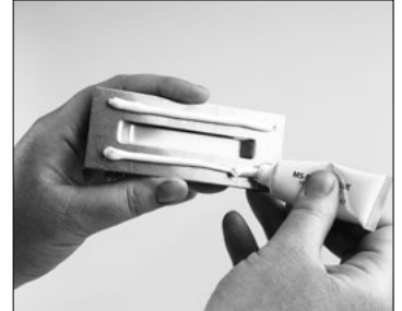
Applicera lim på fästet.
