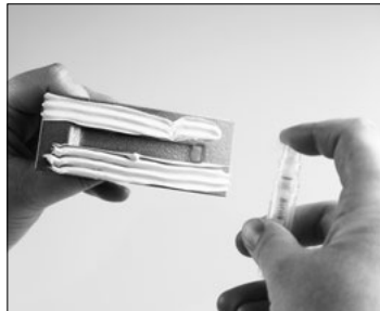
Fuktsätt limmet genom att spraya 2ggr med sprayen.
